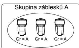
Pokud potřebujete větší výkon blesku nebo si přejete zajistit důmyslnější osvětlení, můžete zvýšit počet vedlejších jednotek. Jednoduše nastavte další vedlejší jednotku pro skupinu záblesků (A, B nebo C), ježíž výkon blesku chcete zvýšit. Neexistuje žádné omezení týkající se počtu jednotek.
